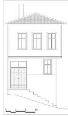
Şekil 20. Restitüsyon- Doğu Cephesi
